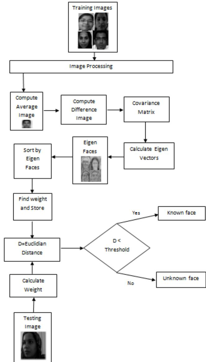
FIG 1. FLOW CHART OF FACE RECOGNITION USING PCA
